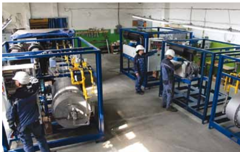
Сборочный цех промышленных парогенераторов ИНТЕРБЛОК
