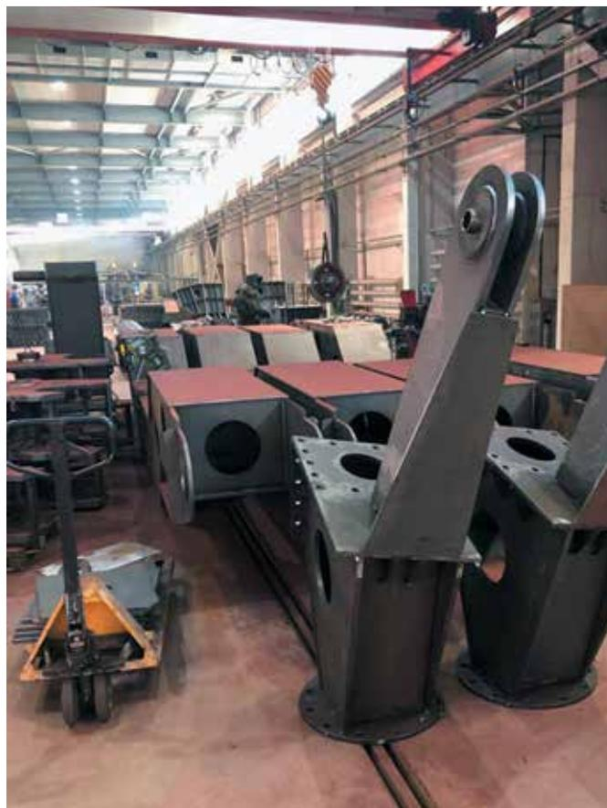
Изготовление узлов подъемно-козлового устройства 280 тонн, контрольная сборка узлов на Механическом заводе «Спецмашмонтаж»
