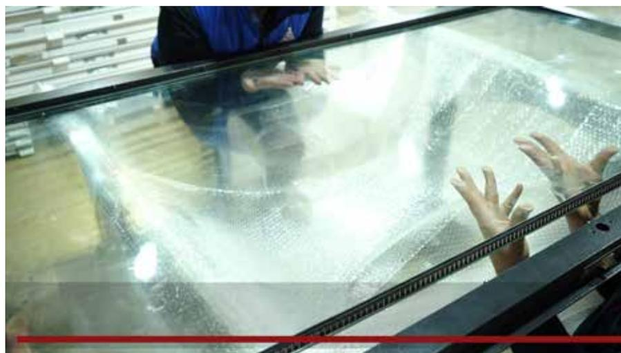
**Компания ДВР Центр** провела испытания своего пожаростойкого стекла класса EIW марки PFG (на безопасность при эксплуатации (удар мягким телом массой 45 кг с высоты 2000 мм, что **соответствует классу защиты СМ4**) в АО Институт стекла, г. Москва. Стекло было представлено в двух исполнениях, испытания прошли успешно, протоколы имеются.
