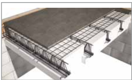
Рис. 8. Конструктивная схема перекрытия МАРКО-ТЕРМО
