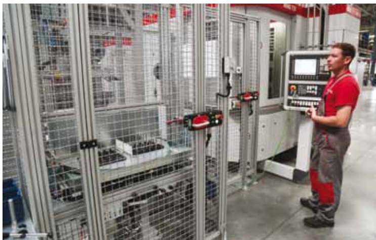
Термообрабатывающий автомат ELDEC для поверхностной закалки деталей токами высокой частоты (ТВЧ)
