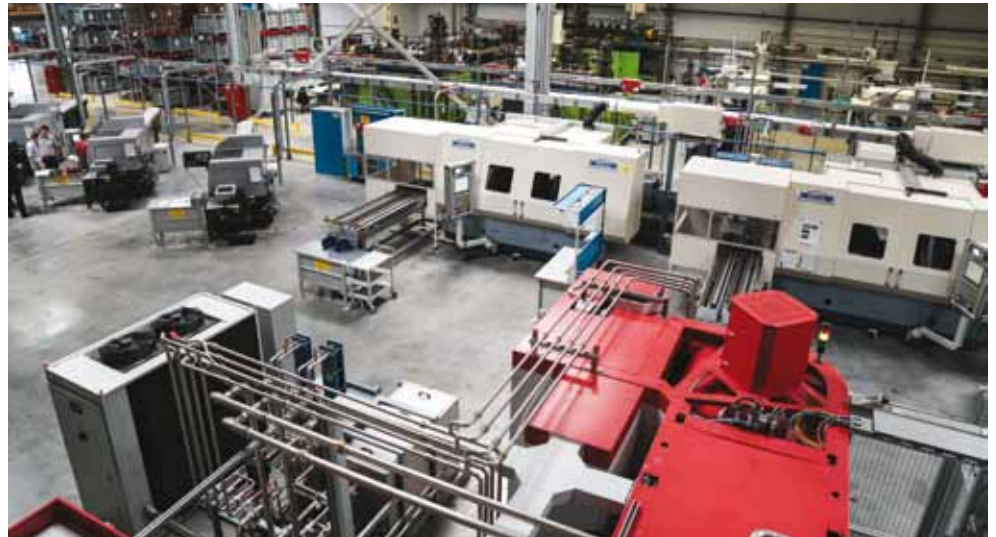
Участок по изготовлению валов якорей для электродвигателей - токарные автоматы TSUGAMI, круглошлифовальные станки WEISS и термообрабатывающие автоматы ELDEC
