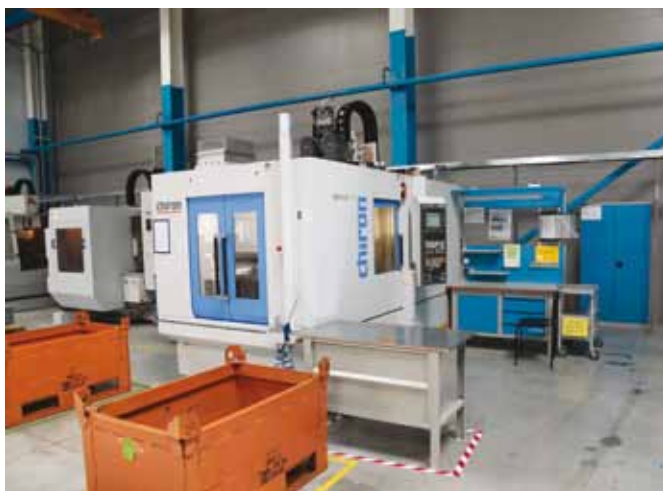
Высокоточные обрабатывающие центры Chiron, выполняющие до десяти технологических операций
