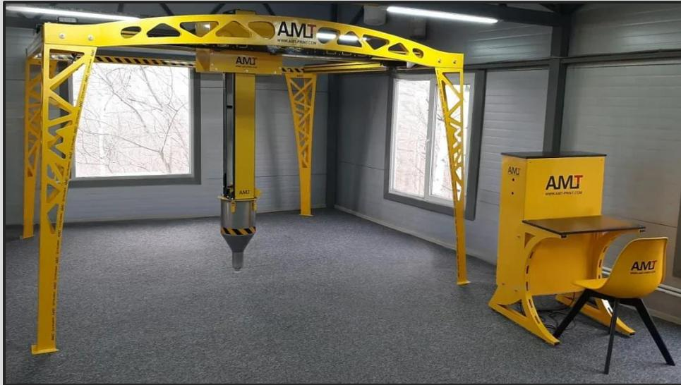
**Цеховые принтеры** - предназначены для печати в условиях цеха малых архитектурных форм, элементов зданий и сооружений, элементов ландшафтного дизайна
