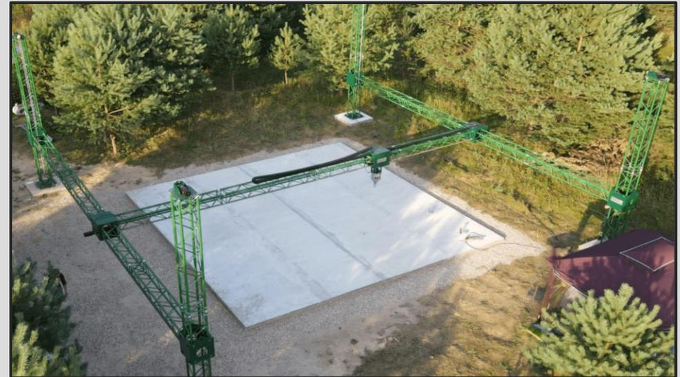
**Полевые принтеры** – предназначены для печати зданий и сооружений непосредственно на фундаменте
